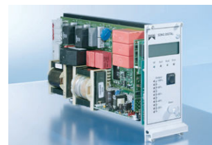
SONIC DIGITAL MG Générateur d'ultrasons modulaire
